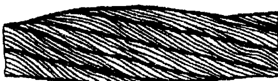
Рисунок 13. Местное увеличение диаметра каната
