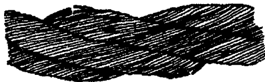
Рисунок 1. Обрывы и смещения проволок каната крестовой свивки
